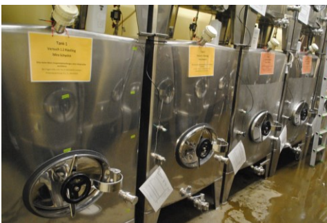
Abb. 2 Versuche zur Gärkühlung in 1200-Liter-Tanks.
